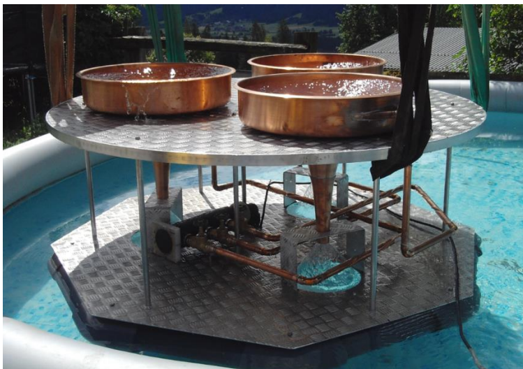
Belebungsinsel für eine schadstoff-belastete Lagune an der Nordsee; Umwälzung 12.000 Liter Schmutzwasser/Stunde
